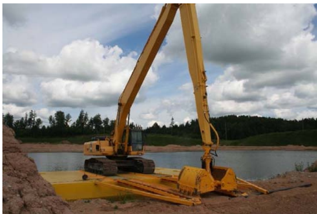
Foto 1. Pikkpoom greiferkopp-ekskavaator Komatsu PC350LC kolmeosalisel pantoonparvel.
